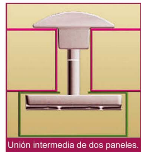
Sujeción del panel al perfil.
